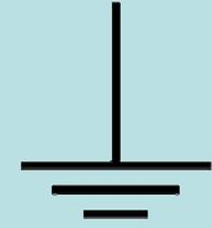
Nel sistema di protezione contro i contatti indiretti la funzione dell'impianto di terra è quella di convogliare verso terra la *corrente di guasto* che, altrimenti, potrebbe farlo attraversando un corpo umano.
