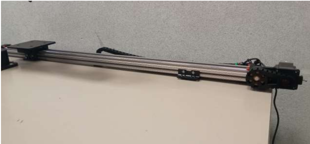
Rotaia lineare per estensione campo di azione braccio robotico Dobot Magician
